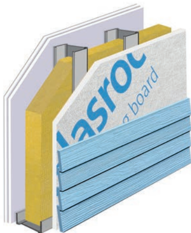
Muro exterior de estrutura simples com envoltente exterior
